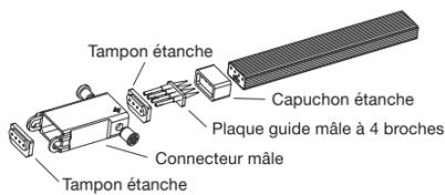
1. Insérez le capuchon étanche dans l'eStrip LED en vous assurant que les cavités d'arrêt soient alignées avec le fil de cuivre nu de l'eStrip LED.
