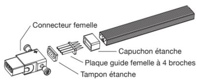
1. Insérez le capuchon étanche dans l'eStrip LED en vous assurant que les cavités d'arrêt soient alignées avec le fil de cuivre nu de l'eStrip LED.
