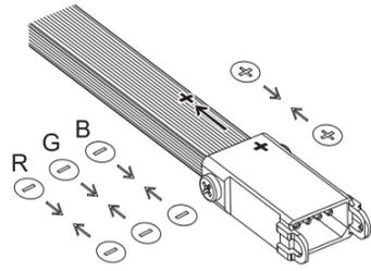
**MISE EN GARDE DE POLARITÉ !** Pour la connexion du connecteur mâle sur l'eStrip LED, assurez-vous que l'indicatif + sur le connecteur soit aligné avec l'indicatif + sur l'eStrip LED avec la flèche sur l'eStrip LED pointant À L'ÉCART DU BLOC D'ALIMENTATION.
