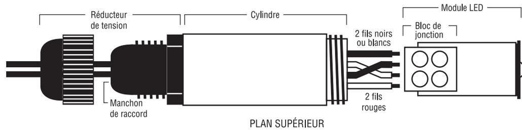
5. Démontez la lampe Disc LED selon le diagramme ci-dessous. Amenez le fil conducteur de la commande LED aux lampes Disc LED et enlevez l'isolant du fil pour laisser à nu 0,95 cm (3/8 po) du fil en cuivre.
