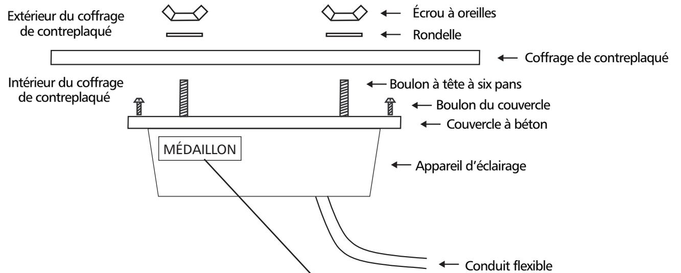
boulon soit en contact avec le côté arrière du couvercle à béton. Répétez la procédure pour le second boulon. Vissez le couvercle à béton sur l'appareil d'éclairage en utilisant les deux boulons de couvercle fournis.
