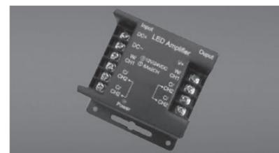
**SOMMAIRE :** L'amplificateur CCT reçoit le signal de modulation de largeur d'impulsion (PWM) du contrôleur vous permettant d'installer des longueurs multiples à partir d'un seul contrôleur. Elles sont alimentées individuellement par un bloc d'alimentation de classe 2. Le bloc d'alimentation de courant devrait correspondre au wattage de la longueur de bande de série Strip LED CCT que vous contrôlez.
