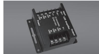
**SOMMAIRE :** L'amplificateur RVB reçoit le signal de modulation de largeur d'impulsion (PWM) du contrôleur vous permettant d'installer des longueurs multiples à partir d'un seul contrôleur. Elles sont alimentées individuellement par un bloc d'alimentation de classe 2. Le bloc d'alimentation de courant devrait correspondre au wattage de la longueur de bande de série Strip LED que vous contrôlez.
